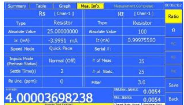
MI は、お客様が校正を行う上での不確かさに影響を与える項目（バジェット）を理解しており、新しく計測器を設計する場合は不確かさを小さくする工夫を入れています。6020T スタンダードと 6020T プレミアムは正面に 6 チャンルのセンサ接続端子が付いており、常時 1 mA の計測電流を流すことが可能です。計測器とスキャナーを組み合わせることも可能ですが、この 6020T は 1 台で実現しています。ブリッジとスキャナーを組み合わせるのは MI だけです！
